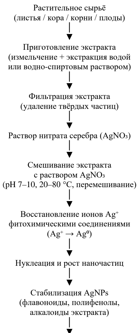
Схема 1. Последовательность действий в синтезе наночастиц серебра химическим взаимодействием.
