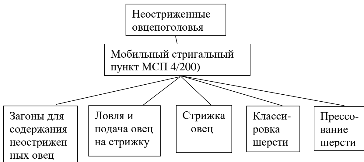
Рис. 1. Технологическая схема стрижки овец на мобильном стригальном пункте
